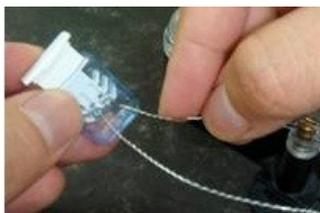
1. Führen Sie den Plombendraht durch die Rückseite der Plombe.
