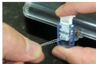
2. Kontrollieren Sie, ob der Draht durch die Verankerung der Plombe geführt wurde.
