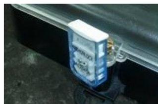
5. Dieses Foto stellt ein korrekt angebrachtes AnchorLock dar.
