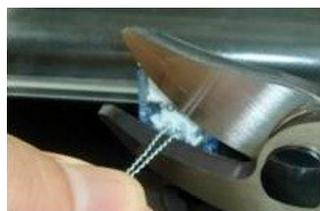
4. Benutzen Sie eine Drahtschere, um überstehenden Draht abzutrennen und Verletzungsgefahr auszuschließen.
