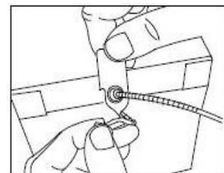
4. Entfernen Sie die Plombe per Hand oder mit einer Drahtschere.
